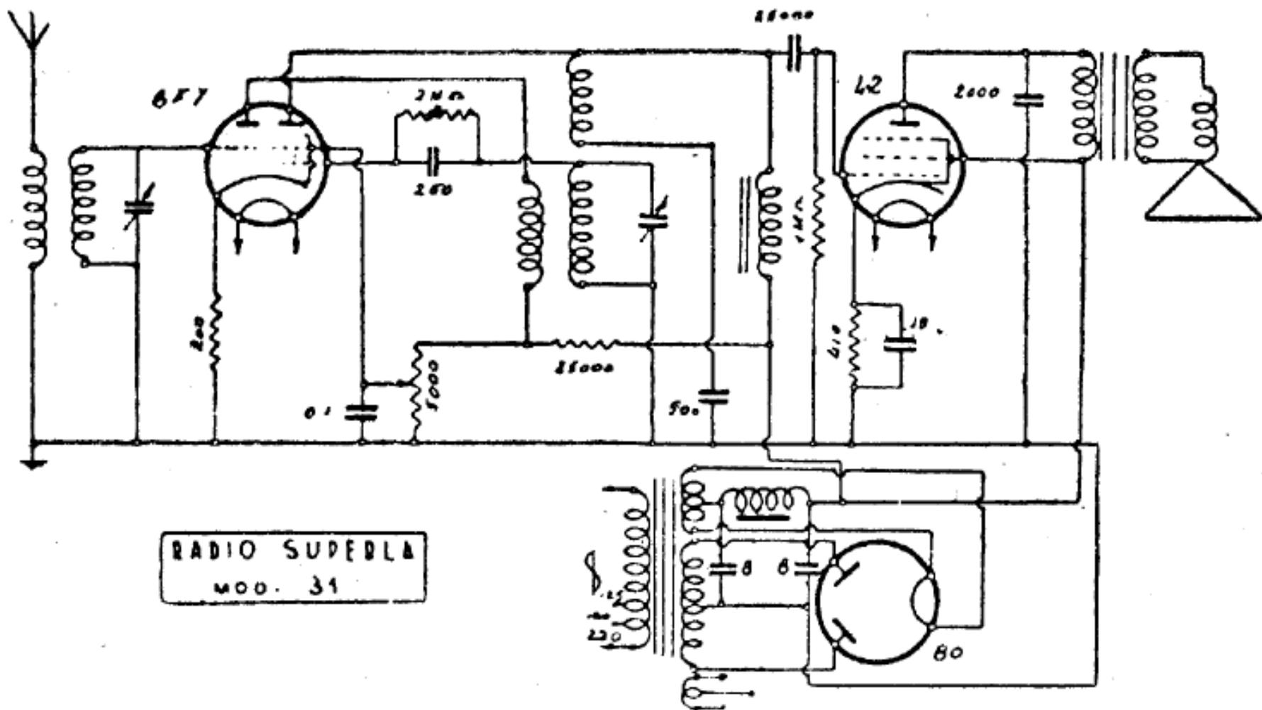
Circuito: amplificazione diretta con reazione. - Amplificazione in alta  $f$ , e demodulazione con valvola multipla 6F7: triodo amplificatore e pentodo demodulatore. - Accoppiamento alla finale per impedenza-capacità. - C. V.
